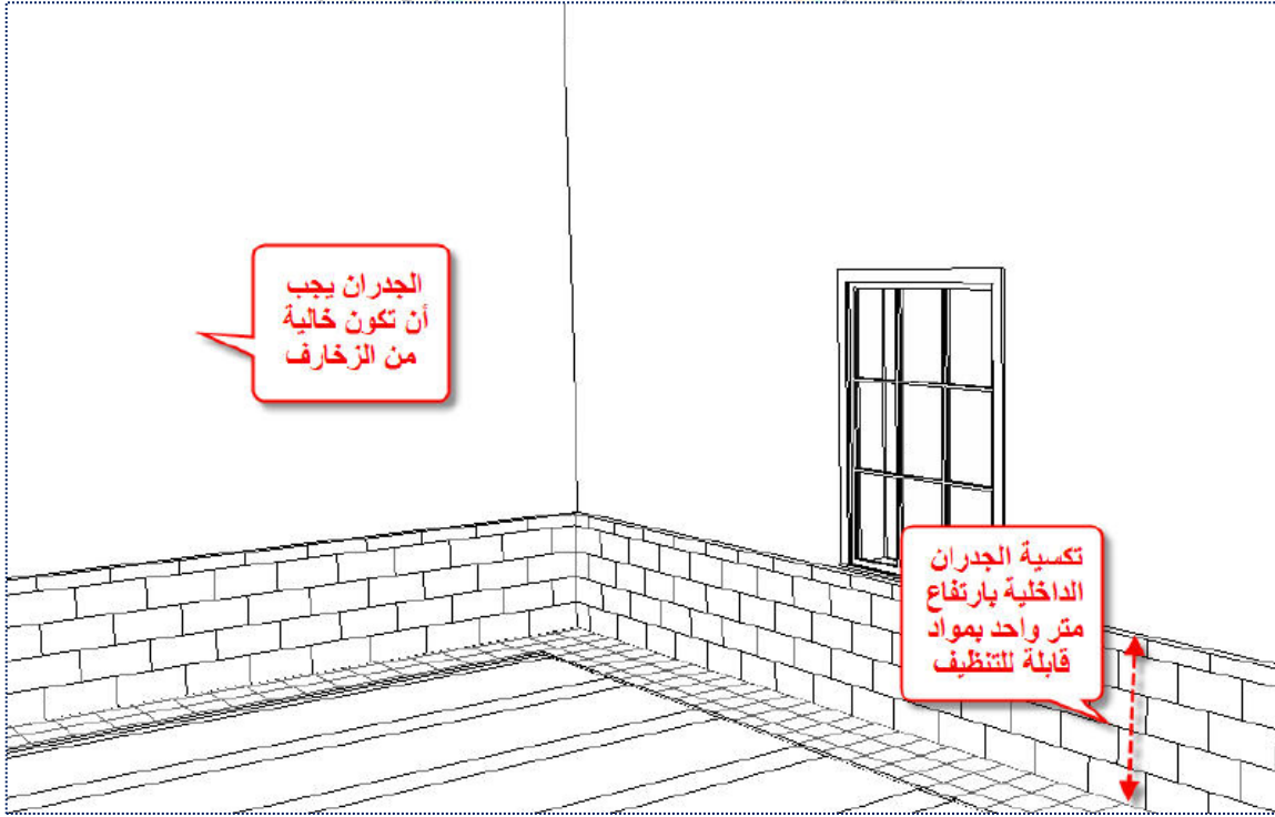
شكل (٤-٤٥)، تكسيه جدران المسجد الداخلية. المصدر: الموسى ٢٠١٧م
